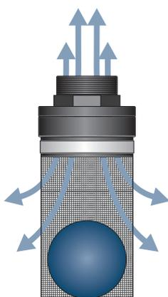
Solange das Flutniveau unterhalb der Überflutungssperre liegt, ist eine ungehinderte Be- und Entlüftung möglich.
