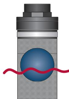
Steigt das Flutniveau weiter an, wird der Schwimmer der Überflutungssperre angehoben.
