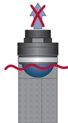
Sobald der Schwimmer den Dichtsitz der Überflutungssperre erreicht, verschliesst diese tropf dicht und verhindert dadurch jegliches Einsaugen verkeimten Wassers.
