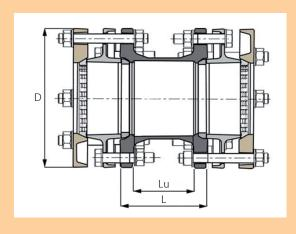
Avec le nouveau manchon Novo-Sit SPEZIAL, il est maintenant possible de raccorder entre eux avec verrouillage des tuyaux coupés et ce avec le système éprouvé Novo-Sit. Le manchon Novo-Sit SPEZIAL est disponible dans l'assortiment de base en dimensions DN 80 jusqu'à DN 300 pour pressions de service jusqu'à 100 bar (selon dimensions et classes de pression).
