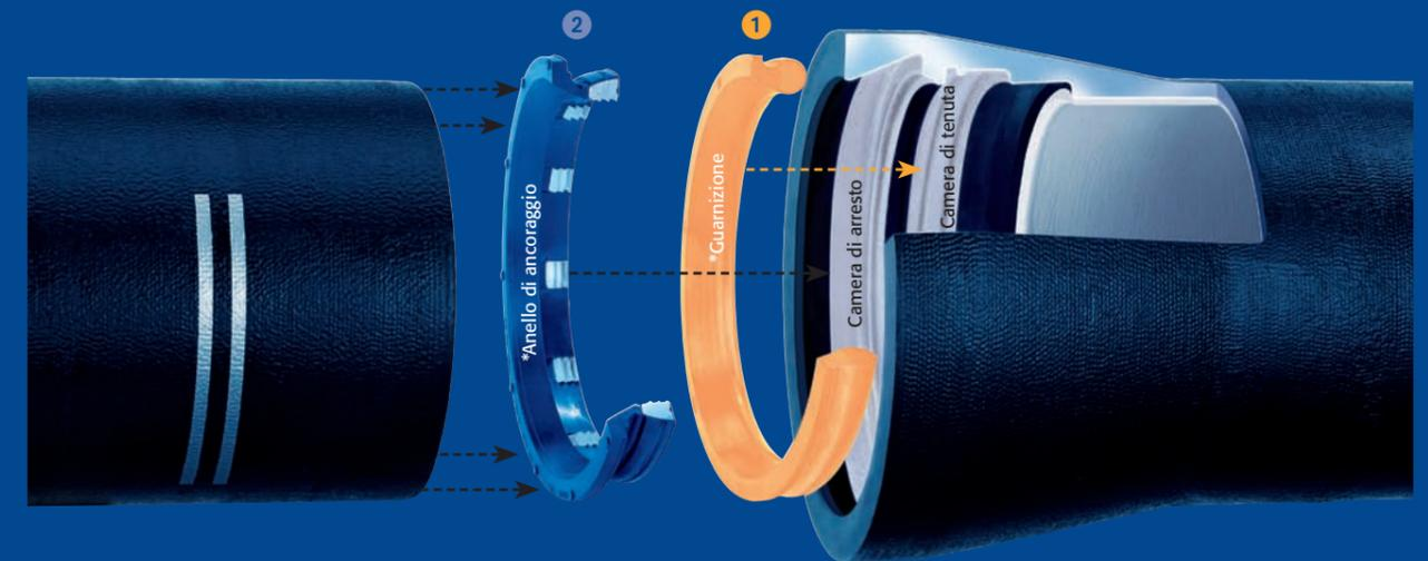
1 A seconda delle esigenze, nella camera di tenuta vengono inseriti la guarnizione TYTON o l'anello TYTON-SIT.
